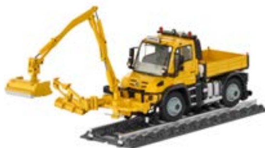
UNIMOG U430 ZWEIWEGEFAHRZEUG MIT KOMBINATIONSMÄHGERÄT
