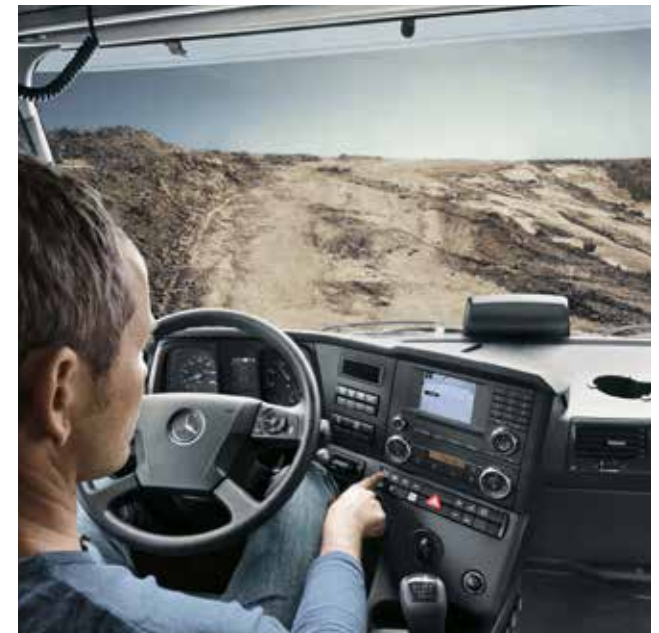
Leichter anfahren am Hang. Bei Aktivierung der Rückrollsperrung verhindert diese das Zurückrollen beim Anfahren. Und die Kriechfunktion der Schaltautomatik Mercedes PowerShift 3 erleichtert das Anfahren.
