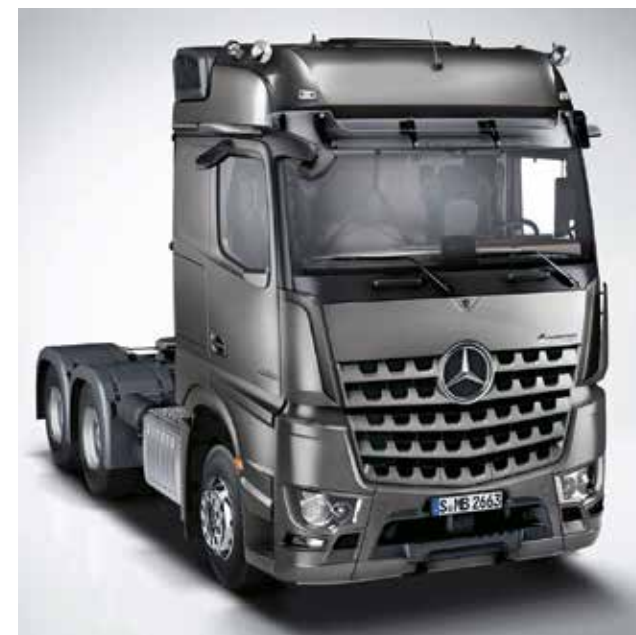
L-Fahrerhaus BigSpace . Die Kabine mit ebenem Boden und 2500 mm Breite bietet mit 1,99 m Stehhöhe zwischen den Sitzen außergewöhnlich viel Bewegungsfreiheit und einen bequemen Durchgang zur Beifahrerseite.
