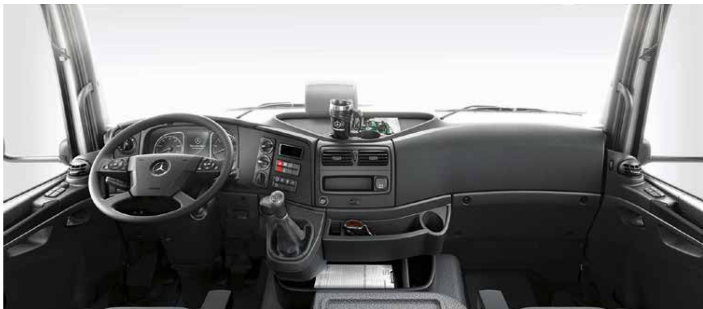
Classic Cockpit. Das Classic Cockpit des Atego ist mit seinen zahlreichen Ablagen hervorragend für den Einsatz im Baunebengewerbe ausgelegt. Alles ist ergonomisch und in Griffweite des Fahrers angeordnet.
