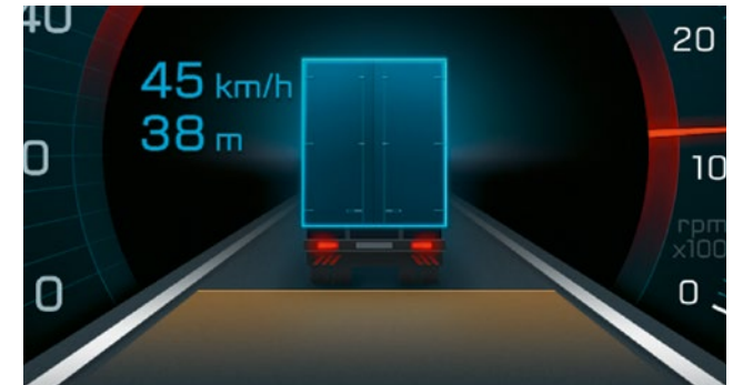
Abstandshalte-Assistent 6) . Das Assistenzsystem mit Stop-and-go-Funktion kann den Fahrer in bestimmten Situationen unterstützen und das Risiko von Auffahrunfällen minimieren.
